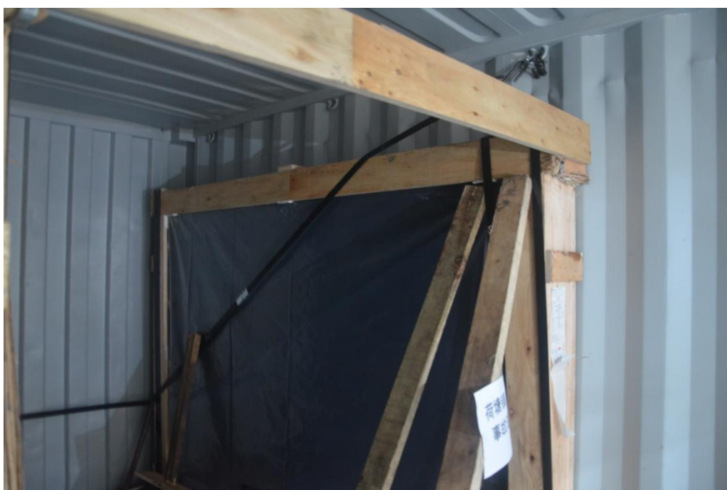
图 5 车厢内摆放着固定好的货物（玻璃）
