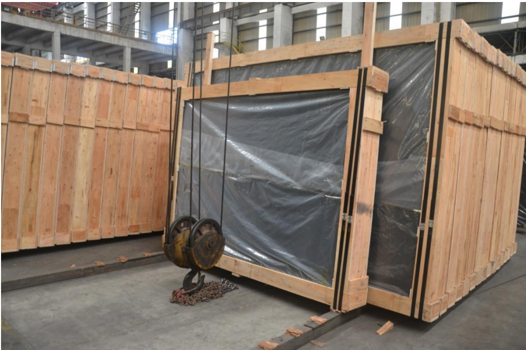
图 2 行吊吊起玻璃的位置
