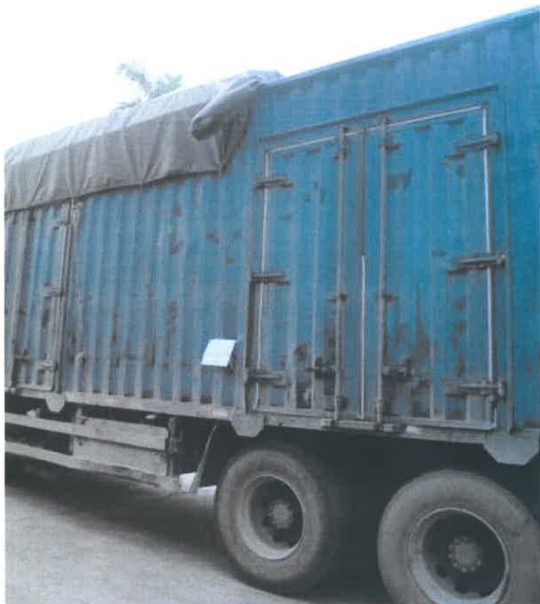
图二 涉事货车仓棚式厢体顶端遮盖篷布部分未作有效固定
